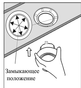
Установка диффузора в корпусе. Одна насечка должна быть направлена в середину места фиксации.
